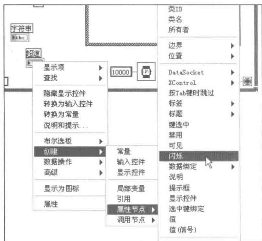
图 8-39 用鼠标右键创建属性节点
