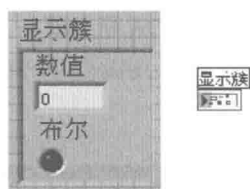
图 4-4 创建显示控件簇
