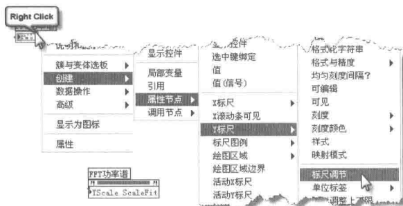
图 20-14 标尺调节属性节点的创建
