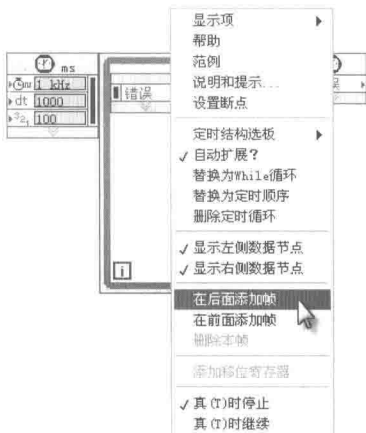
图 30-44 在“定时循环”结构中添加帧
