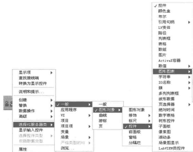
图 30-34 “控件引用句柄” VI 服务器类配置
