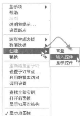
图 19-7 通过快捷菜单创建输入控件
